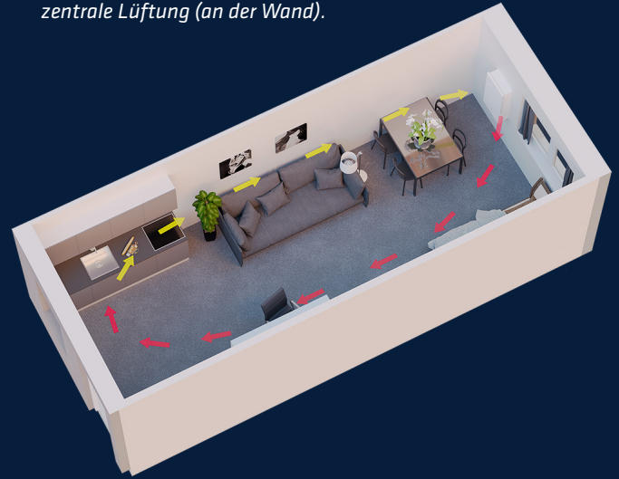
Studio mit Ease 100 als semi-zentrale Lüftung (an der Wand).
